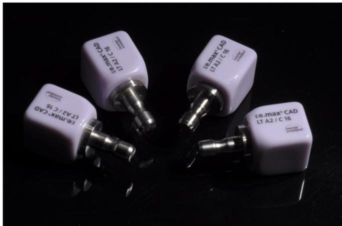
Figura 12: blocchetti di disilicato di litio per la lavorazione CAD/CAM
